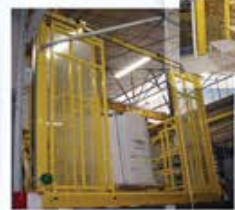
Barrière de type LS entièrement automatisée avec des garde-corps coulissants à l'avant et un système de barrière levante à l'arrière.
