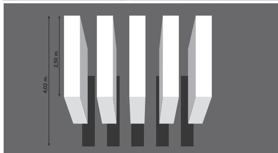
La réglementation des passages piétons impose un écart minimum de 50 cm jusqu'à 80 cm entre chaque bande blanche.
